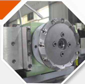
重切削ギア摺動スピンドル Heavy-cutting gear box spindle
